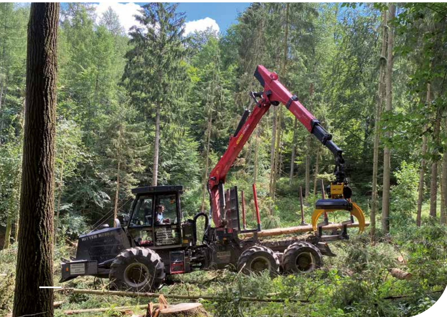
Skidder de la marca Ritter con cabezal de tala GMT050 y sistema de enganche rápido GMT C10
