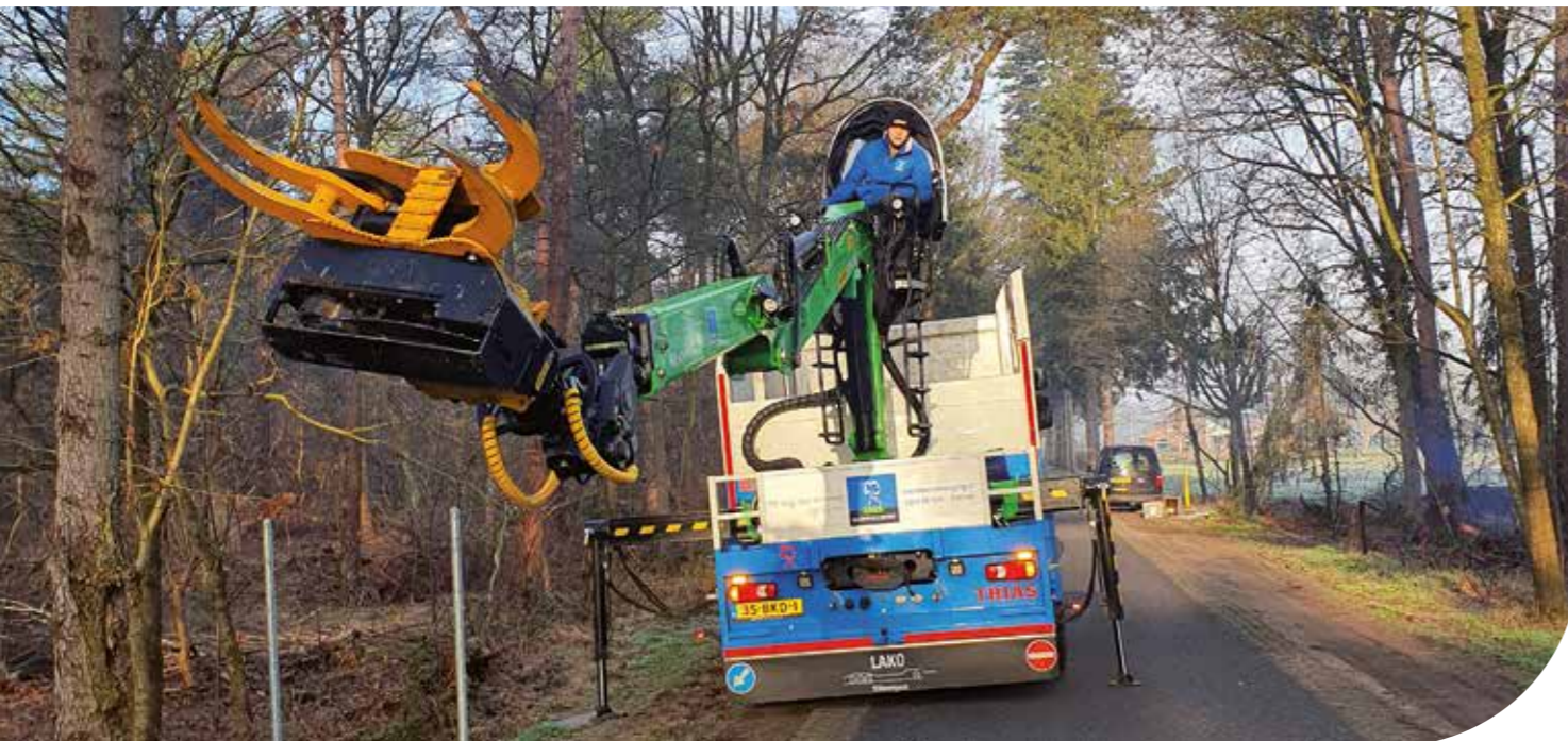
Camión con cabezal de tala GMT035TTC y sistema de enganche rápido GMT C10
