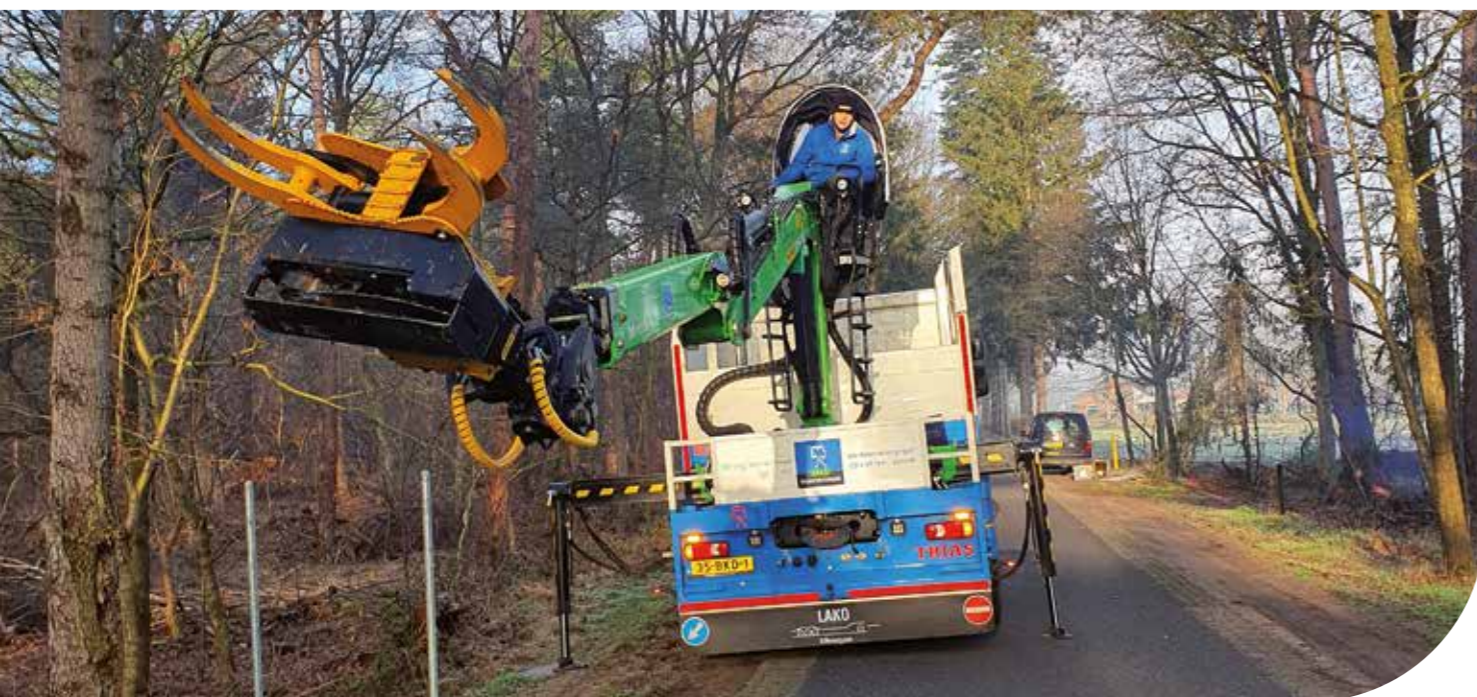
Camion avec grappin scie GMT035TTC et système de fixation rapide GMT C10
