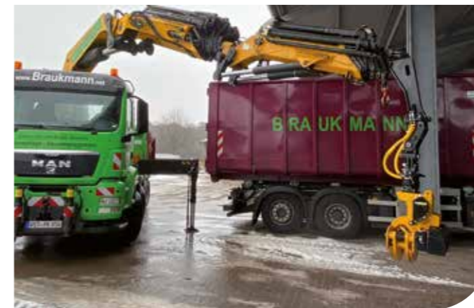
GMT050TTC avec bras d'extension pour grue de manutention
