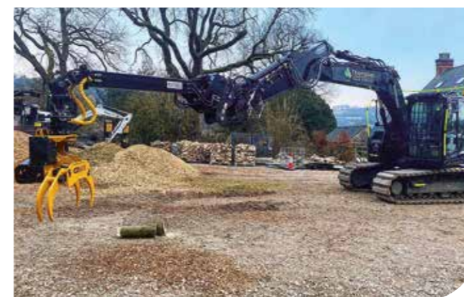
GMT035TTC avec bras d'extension pour pelleuse
