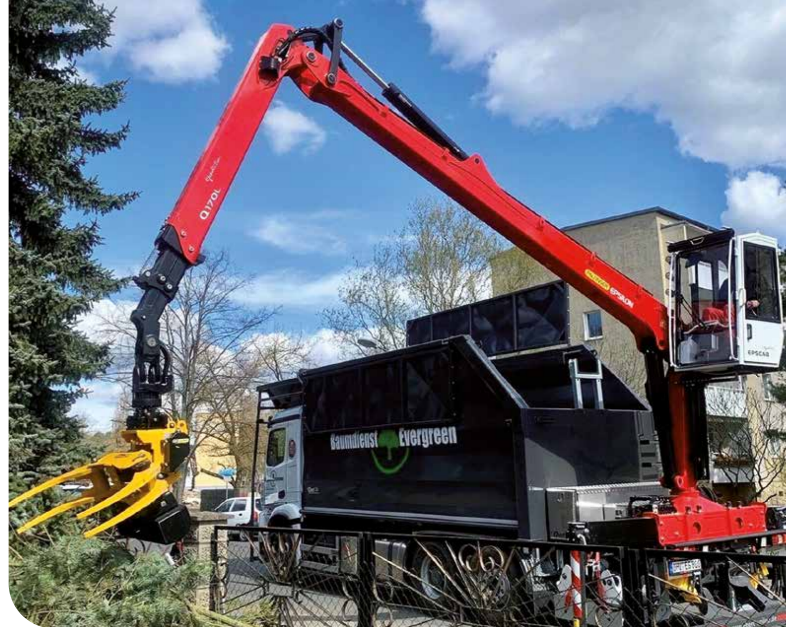
Camion avec grappin scie GMT050 et systeme de fixation rapide GMT C10
