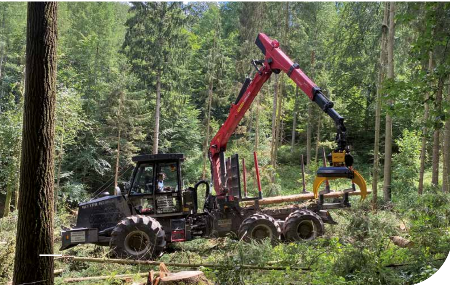
Débusqueur Ritter avec grappin scie GMT050 et système de fixation rapide GMT C10
