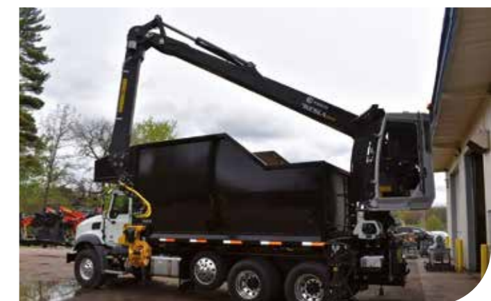
GMT050TTC avec adaptateur de point d'arrimage pour grue de forestière
